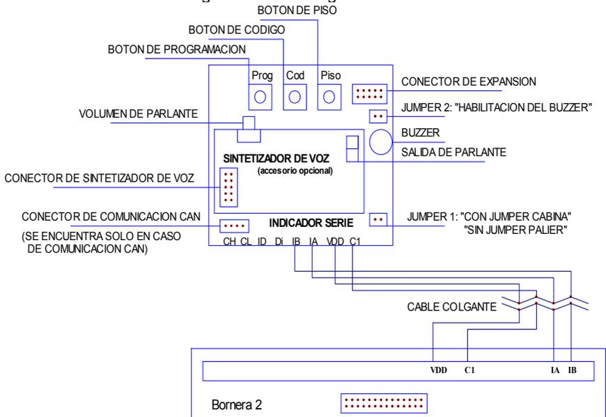
Figura 1. Conexionado del Display Alfanumérico Serie
