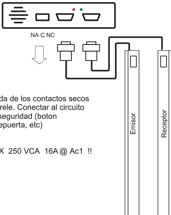
salida de los contactos secos del rele. Conectar al circuito de seguridad (boton abrepuerta, etc)
