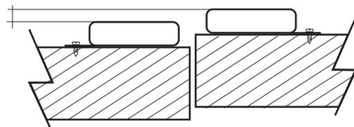
Con las puertas cerradas los barrales deben quedar en el mismo plano, perfectamente enfrentados y a una distancia de 40 m a 50mm. Si las puertas estan desplazadas aplique arandelas para suplementar el barral. Asegurese que los barrales queden a la misma altura (coloquelos de manera que las flechas coincidan)
