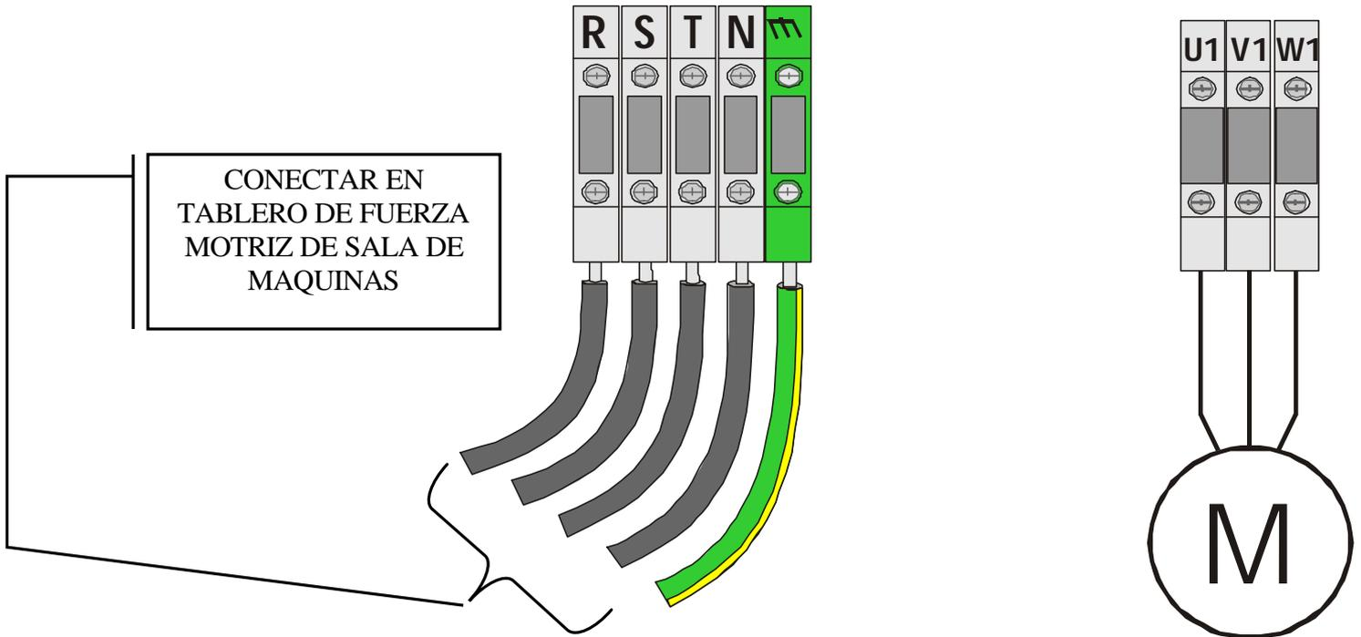
Para el funcionamiento correcto del tablero es **NECESARIO** la conexión del mismo a **TIERRA** a través de una **JABALINA**
